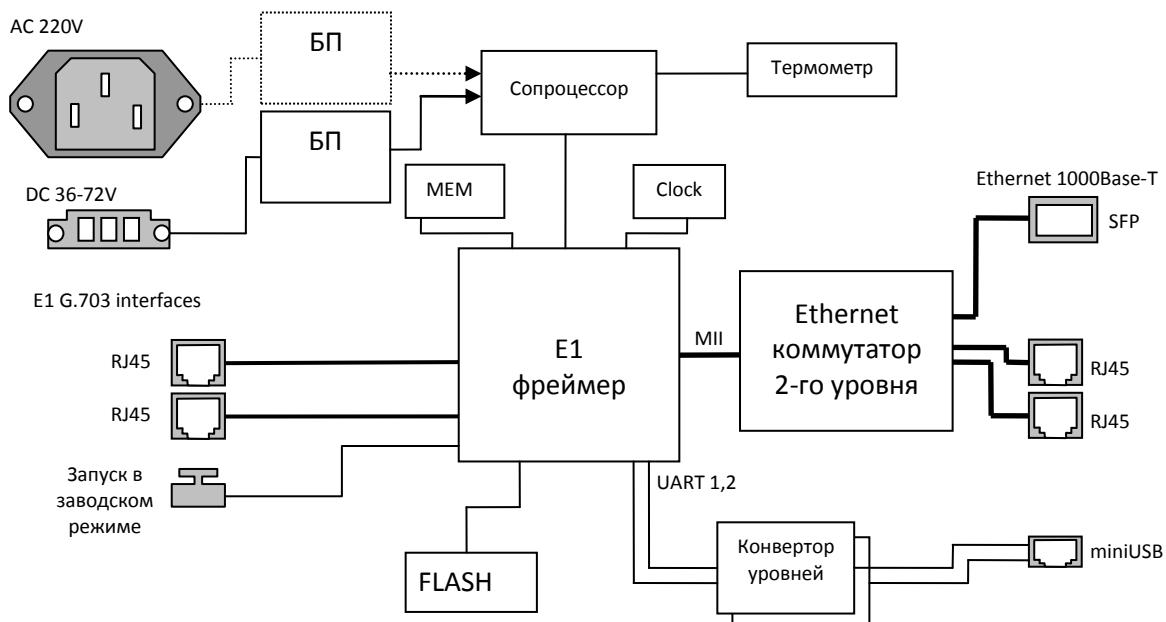
Основные узлы мультиплексора-коммутатора Sprinter TX.
